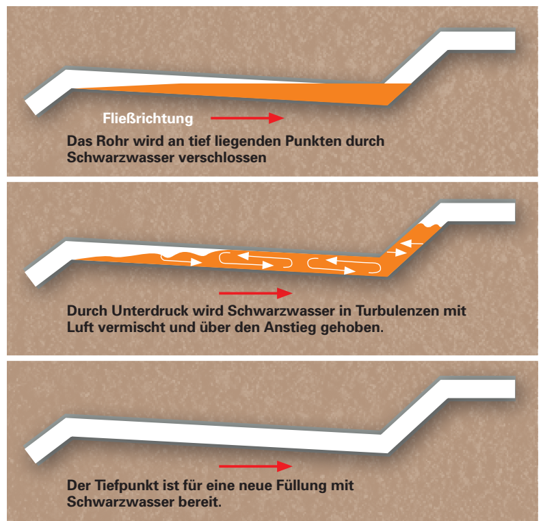
Abbildung 4: Transportvorgänge für eine Unterdruckleitung im Erdreich
